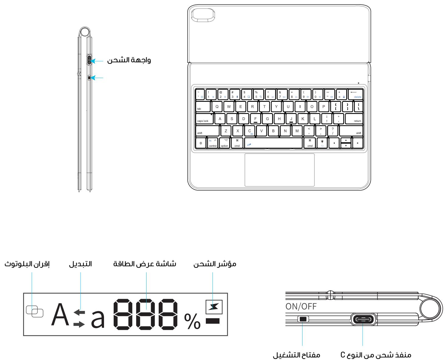
١. أدر المفتاح للأسفل لتشغيل لوحة المفاتيح. ستضيء شاشة العرض. أدر المفتاح للأعلى لإيقاف تشغيل لوحة المفاتيح.
