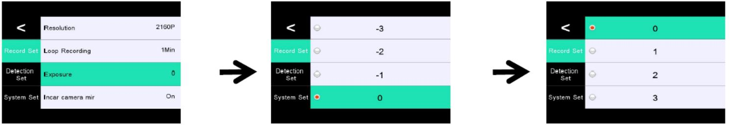
٥.٣ مرآة الكاميرا داخل السيارة: يتيح لك هذا الخيار ضبط الصورة لعرضها كمرآة أو الصورة الأصلية. الإعداد الافتراضي هو إيقاف التشغيل (الانعكاس).
