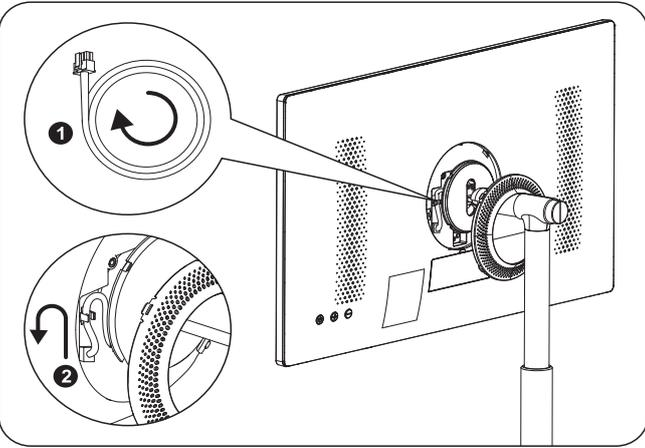
٩. قم بتنظيم سلك الطاقة عن طريق لفه في اتجاه عقارب الساعة، ثم أدخل القابس، ثم قم بترتيب سلك الطاقة بشكل أنيق وضعه في الفتحة المخصصة للتثبيت.
